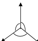
9. Равнодействующая трёх сил, если  $F_1=F_2=F_3=10$  кН.
