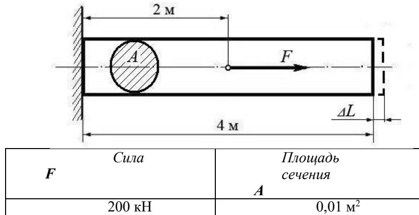
(Ответ: общее удлинение бруса  $\Delta L = FL / (EA) = 2 \times 10^5 \times 2 / 0,4 \times 10^{11} \times 0,01 = 10^{-3} \text{ м или } \Delta L = 1,0 \text{ мм}$ )
