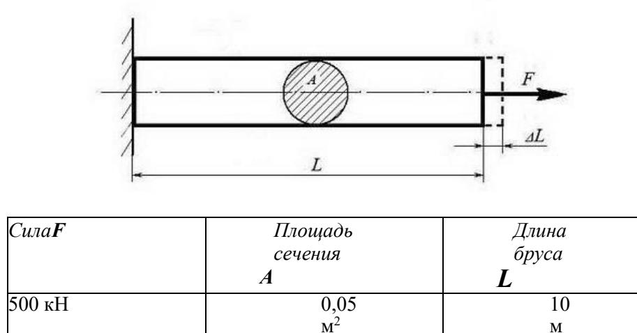
(Ответ: удлинение бруса  $\Delta L = FL / (EA) = 5 \times 10^5 \times 10 / 2 \times 10^{11} \times 0,05 = 5 \times 10^{-4} \text{ м или } \Delta L = 0,5 \text{ мм}$ )
