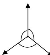
**9. Равнодействующая трёх сил, если  $F_1=F_2=F_3=10 \text{ кН}$ .**
